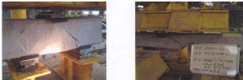
그림 4. PC침목 휨(균열)하중 시험(레일직하부, 중앙부)
