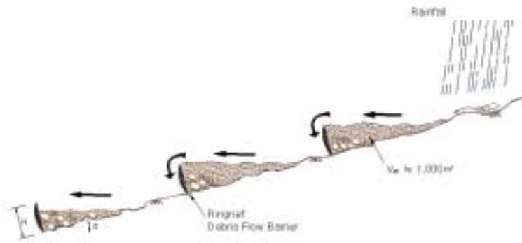
그림 8. 링네트 토석류 방호책 설치개념 (예)
