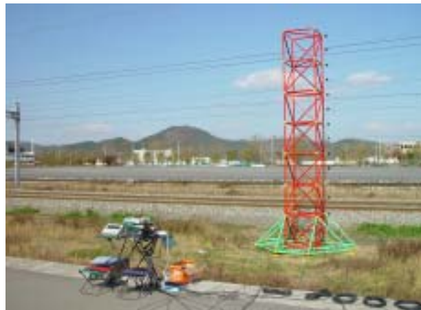
그림 5 철도소음 지향특성 측정 시스템
