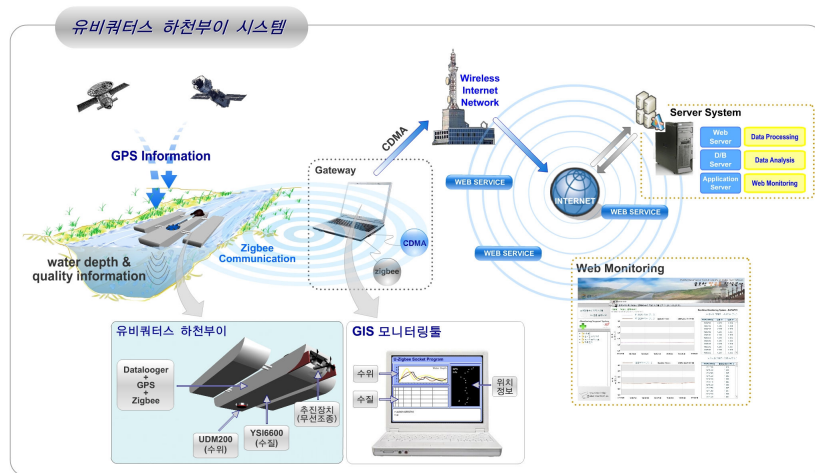
그림 1. 유비쿼터스 하천부이 시스템의 개념도
