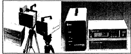
그림 3. 비접촉식 Laser Doppler Vibrometer
