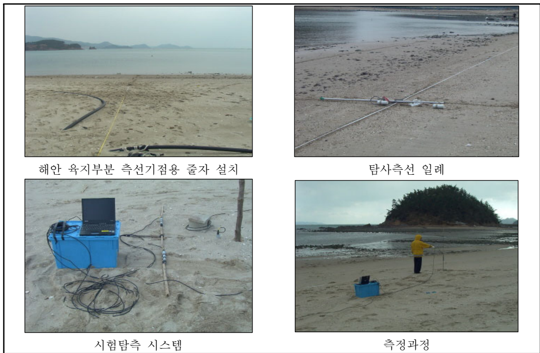
그림 3. 해안 육상부 탐사관련 장면들, 해상에서는 동일하나 보트상에서 해저에인 측정.
