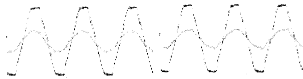
<그림 8> 수동필터만 연결시 입력 전압/전류 파형
