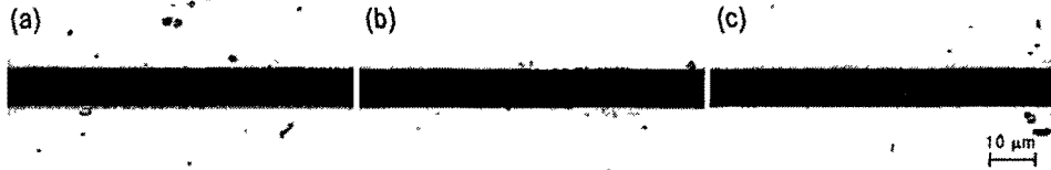
<그림 3> 펄스 반복율 600 kHz에서 조사 선속에 따른 패턴 선폭 변화 (a) 1 mm/sec, (b)10 mm/sec, (c) 20 mm/sec
