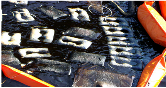
Fig. 9 HNS Gel Pack 흡착제로 방제하는 장면(Oil fence inside)
