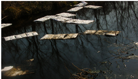
Fig. 11 HNS Gel Pack 흡착제의 방제장면(김해 진례 Bunker A oil 흡유)
