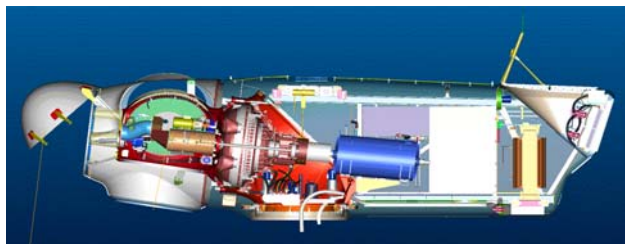
Fig. 1 Inside of the nacelle (Vestas, 3MW class)
