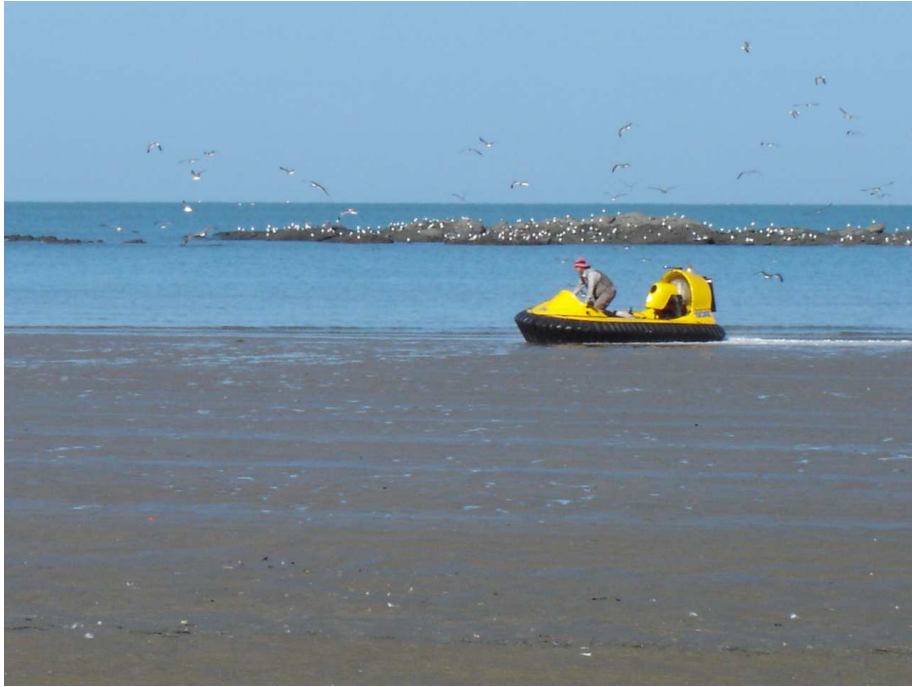
Fig.1 Hovercraft 를 이용한 간석지 측량
