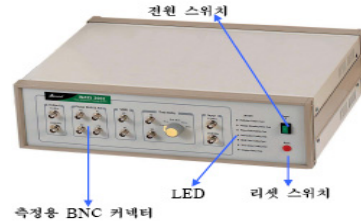
그림 11. 안테나 실험장치의 본체 구성 Fig. 11. Body structure of the antenna experimental equipment
