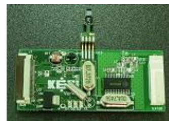
<그림 4> 900MHz RF 기반 Sync Agent H/W 모듈
