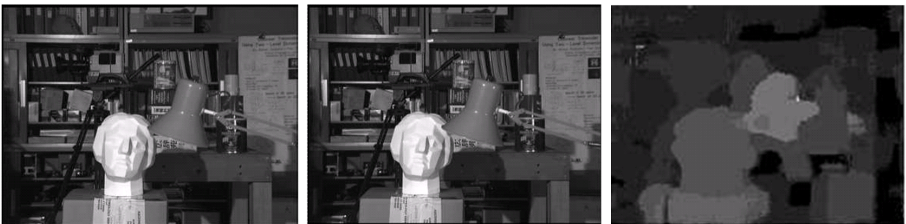
그림 5. (a) 좌측영상 (b) 우측영상 (c) 스테레오 비전 시스템 결과 영상
