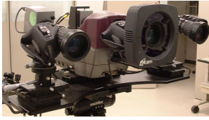
그림 2. 3 시점 및 depth 카메라 시스템
