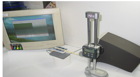
그림 8. 시료의 인식거리 측정.
