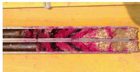
그림 7. 육안관찰에 의한 주입재 침투성 확인(지하철 OO공구)
