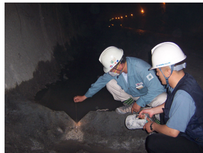
그림 6. 경부고속철도 OO-O공구 V-notch 설치 전경 및 수위측정 전경
