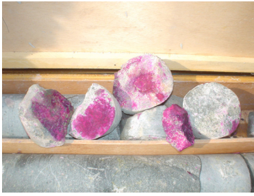
그림 8. 육안관찰에 의한 주입재 침투성확인(경부고속철도 OO-O공구)
