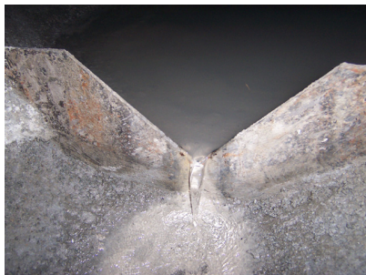
그림 6. 경부고속철도 OO-O공구 V-notch 설치 전경 및 수위측정 전경
