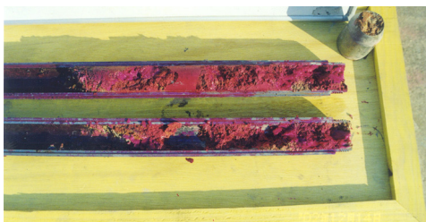
그림 7. 육안관찰에 의한 주입재 침투성 확인(지하철 OO공구)
