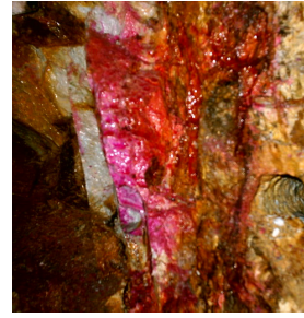
그림 8. 육안관찰에 의한 주입재 침투성확인(경부고속철도 OO-O공구)
