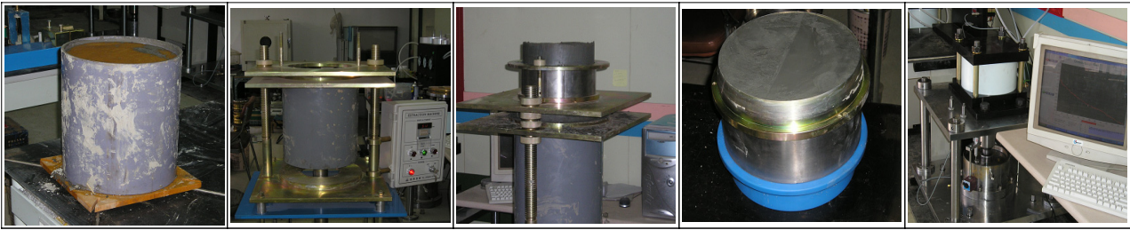
a) 대형자연시료 b) 대형시료추출기 c) 시료 추출 d) 대형압밀시료성형 e) 대형압밀시험
