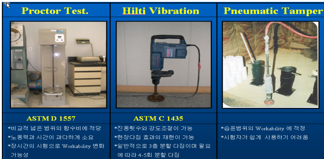
사진 1. 강도시험용 표준공시체 제작방법(미국 RCC 공법기준)
