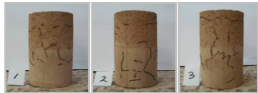
그림 4. 압축 균열이후의 공시체 모습
