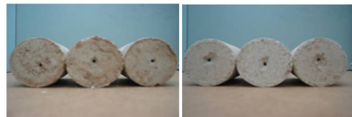
그림 5. 드릴로 홀을 만든 공시체 모습
