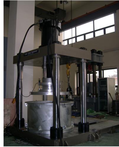
그림 4. 대형 압축 시험기 (수자원공사 수자원연구원)
