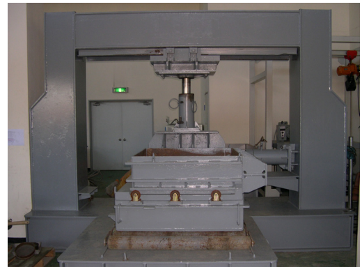
그림 3. 대형 직접 전단시험기 (한국수자원공사 수자원연구원)
