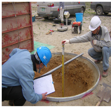
② 시험굴 굴착깊이 측정
