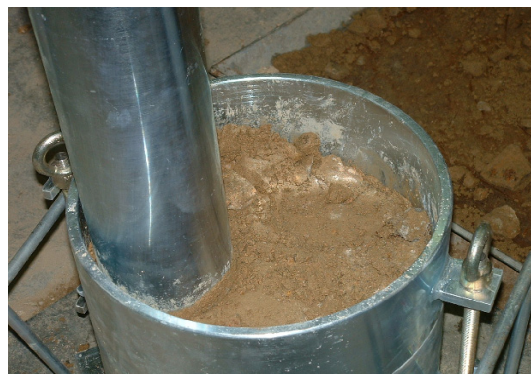
사진 1. 대형다짐기에 의한 실내 다짐시험 전경
