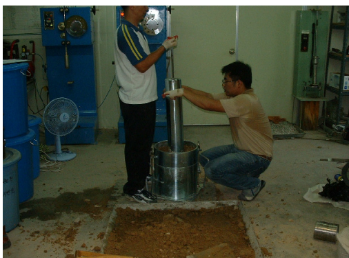
사진 1. 대형다짐기에 의한 실내 다짐시험 전경
