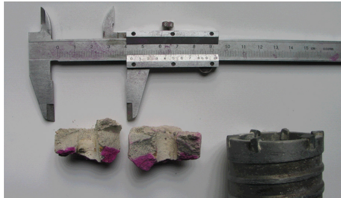
그림 1. 현장에서의 중성화 깊이 측정 전경
