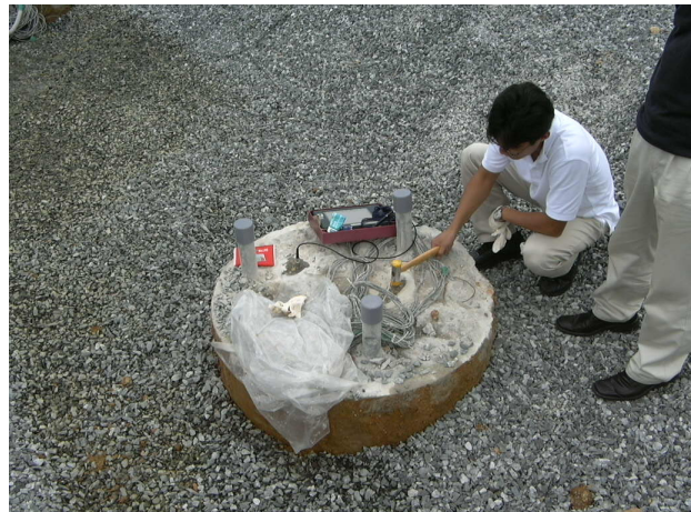
그림 4. 충격반향기법 건전도 검사 모습
