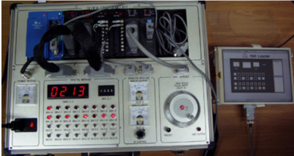
(그림 6) GM6 개발 키트와 HMI 소프트웨어가 수행된 임베디드 기기 연결
