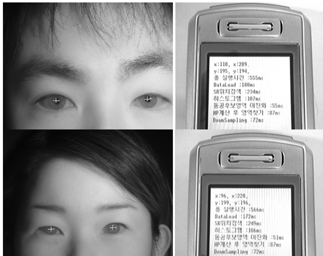
그림 5. 눈 위치 검출의 동일한 알고리즘을 PC와 휴대폰에서 실험 했을 때의 결과
