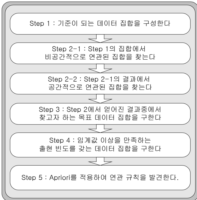
그림 3 GMS 에서의 공간 연관 규칙 탐사 시스템의 흐름도
