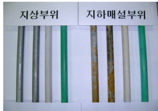
그림 3. 사용 5년 경과된 시료 파이프의 표면부식상태
