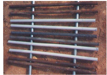
그림 1. 부식 진행중인 시료 샘플의 조건별로 처리된 모습
