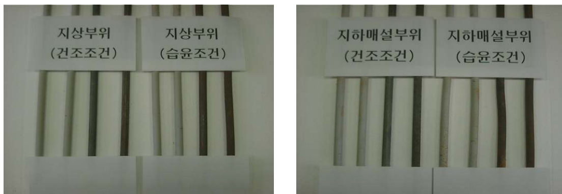
그림 5. 부식재료의 18개월 후 처리별 표면부식상태
