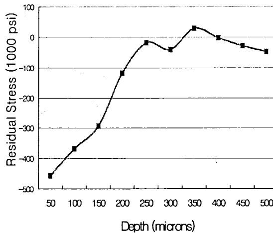
그림 4. 레이저피닝 처리된 금속의 잔류응력 분포
