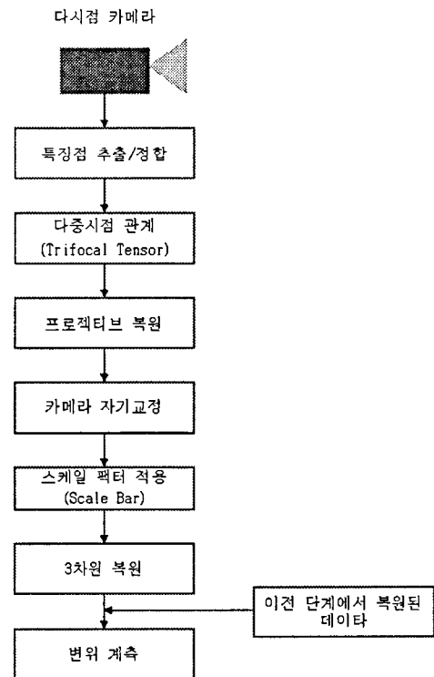
<그림 1> 다시점 카메라를 이용한 구조물의 변위 계측 전체 구성도
