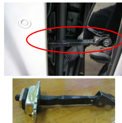
Fig. 6 차량 도어에 부착된 미끄럼 관절
