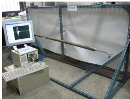
그림 7. Hammer에 의한 Impact-echo 시험 전체 전경
