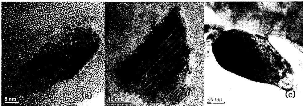
그림 1. [110]방향으로 관찰한 440℃에서 2시간(a), 8시간시효한 시편(b)의 \theta 상과 64시간 시효한 시편에서 나타나는 오스테나이트(c).
