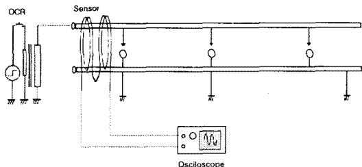
그림 2. 고장 발생 시뮬레이터 구성도
