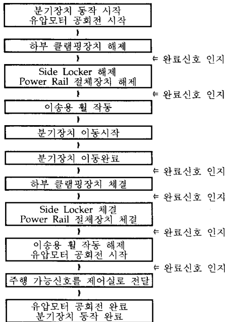
Fig. 2 평행이동식 분기장치의 동작순서
