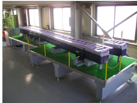
그림 12. 1/5 scale 굴절식 자기부상열차 분기기
