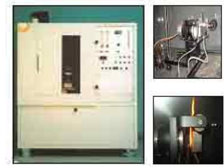
그림 3. 연기밀도챔버 장비 및 복사가열기
