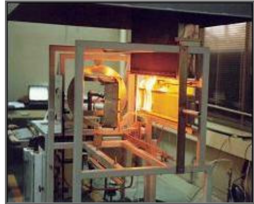
그림 4. 화염전과 시험기 구성도 및 장비 사례
