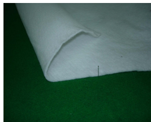
(b) Type B 부직포, 장섬유, 니들펀칭 그림 3. 토목섬유의 종류
