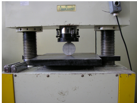
그림 5. 쪼갬 인장시험 전경
