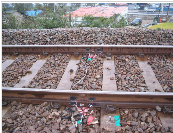
그림8. 슬랙 하선 횡압측정용 센서부착상태
