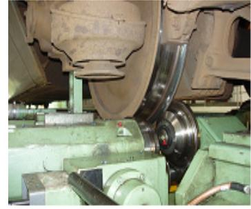
그림 3-1 (a)삭정기 전경 (b) 삭정기 차륜 삭정시 모습
