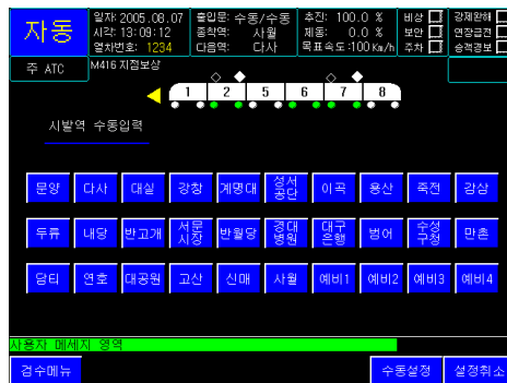
그림3) TCMS화면장치의 수동지점보정 시스템 개념도
