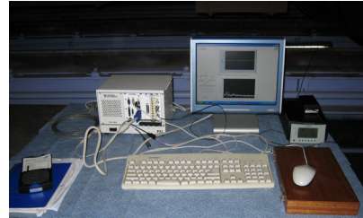
그림19 제동력 작용 시 진동주파수 측정
