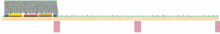
그림 4. 고가궤도 유한요소 모델
