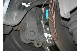
사진 5. 제륜자에 온도센서 설치
