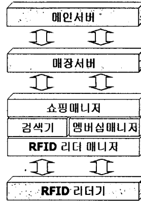
[그림 3] RFID 리더 단말기의 가상 쇼핑카트 아키텍처
