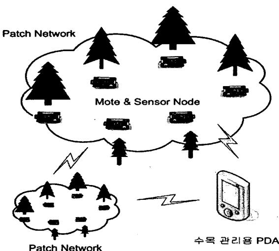
그림 6. 수목 관리용 PDA 시스템 구성
