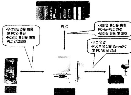
그림 4. 전체 시스템 구성도
