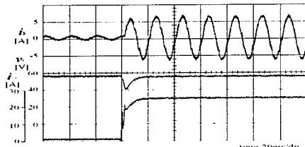
그림 9 부하변동시의 응답 과정(부하전류 0[A]⇒26[A])
