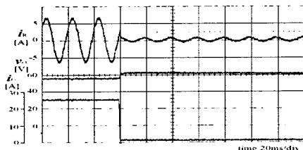
그림 8 부하변동시의 응답 과정(부하전류 26[A]⇒0[A])
