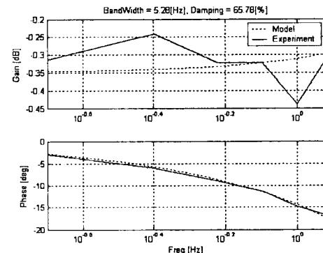
그림 5. 확장 칼만 필터를 이용한 보드선도.
